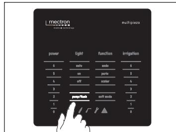
Pendant que le voyant PUMP/FLUSH clignote, appuyer sur la pédale une fois et relâcher, PUMP/FLUSH arrête de clignoter et le circuit d'irrigation commence à se remplir;
