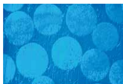
Section transverse du tenon
