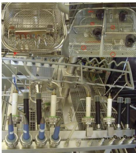
Exemple de placement correct des pièces.
