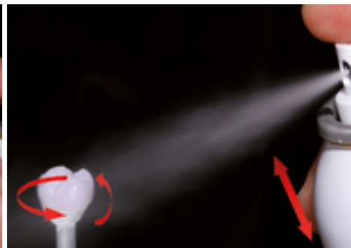
Vaporiser IPS e.max CAD Crystall./Glaze Spray directement sur l'IPS e.max CAD Crystall./Shades and Stains non cuit. Pulvériser la restauration sur toutes les faces en la faisant tourner simultanément.
