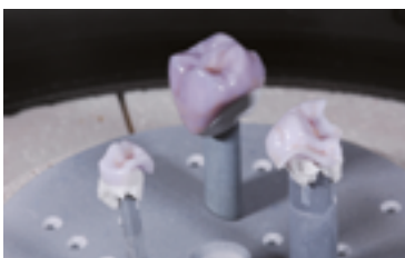
Poser la restauration au centre du support IPS e.max CAD Crystallization Tray et cristalliser selon les paramètres de cuisson indiqués.
