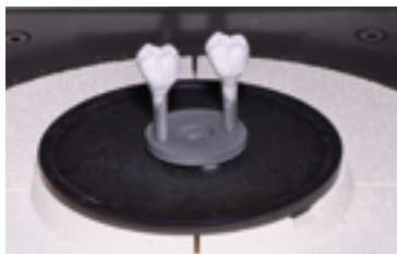
Placer le support de cuisson IPS e.max CAD Speed Crystallization Tray comportant un maximum de deux restaurations PS e.max CAD HT/MT/LT dans le four et cuire selon les paramètres de la cuisson de cristallisation Speed.
