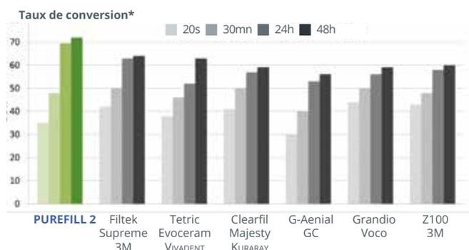
\* Tests réalisés par G-Pharma. Taux de rétraction selon norme ISO 17304; Résistance à la flexion selon norme ISO4049 - banc de test Zwick. Taux de conversion par infrarouge en mode ATR. La polymérisation par lampe Elosdent 9mm de diamètre - puissance 600mW/cm<sup>2</sup> à température ambiante (20°C).
