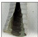
Biofilm dans le tuyau d'aspiration
