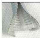
Aucune trace de biofilm dans le tuyau d'aspiration
