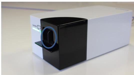
Lorsque la LED verte clignote, retirer la protection cartonnée, pour ne laisser que la plaque.
