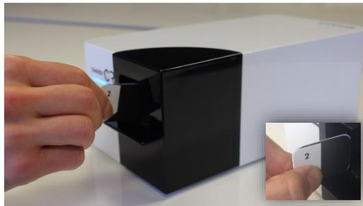
Lorsque l'Owandy CR<sup>2</sup> est sous tension, la LED verte est allumée. Insérer alors horizontalement la protection cartonnée avec la plaque dans la fente jusqu'à ce que la LED verte clignote.
