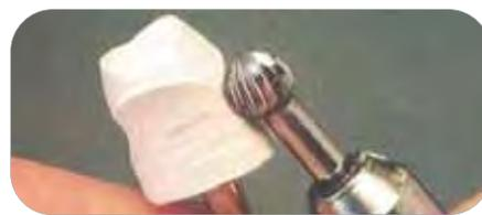
Fraise Carbure de détournage
