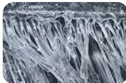
Image MEB montre une excellente pénétration de Optibond dans la dentine déminéralisée, la formation des étiquettes de résine long et une bien définis couche hybride, qui se traduit par strength de liaison supérieure.
