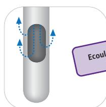
Écoulement des liquides résultant des ouvertures latérales
