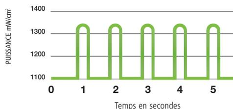
Pour chaque seconde du cycle de polymérisation, le PLS fait passer la puissance des LEDs d'une valeur plancher de 1.100 mW/cm<sup>2</sup> à une valeur de pointe de 1.330 mW/cm<sup>2</sup> pendant un quart de seconde. La puissance pulsée délivrée assure une polymérisation rapide et une réduction de la chaleur émise.
