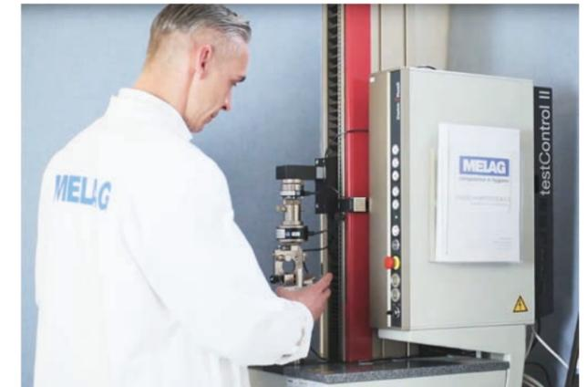
Les experts dans le domaine de l'hygiène recommandent de contrôler **tous les ans** la bonne résistance à la traction des joints de scellage à titre de contrôle routinier et pour la validation des processus d'emballage avec les soudeuses MELAG.
