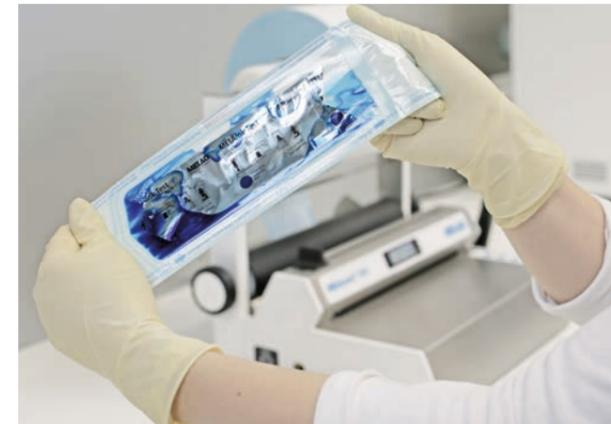
Le test à l'encre **MELAink** est un moyen fiable pour contrôler une fois par semaine l'étanchéité des joints de scellage selon DIN EN ISO 11607-1 et ASTM F1929-12.
